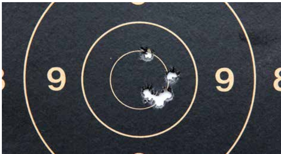
Seks skot på 100 meter med tre skot for Brownells 52" med Remington 700/ Swarovski Z8 fire gonger vart kasta ut frå andre etasje, og tre skot etter utkasting.
